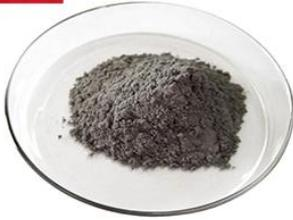
**铱粉(> 1500 元/克)**应用于工业及医学、科学中。的应用大部份运用其高熔点、和抗腐蚀性质。依金属以及- 铂合金和合金的耗损很低用途:制造多孔喷丝板。飞机引擎中的一些长期使用部件是由银合金组合金也被用作水底管道材料。放射性同位素  $^{192}\text{Ir}$  在  $\gamma$  射线照相中是一种重要的能源,有行无损检测。另外,近距离治疗利用  $^{192}\text{Ir}$  所释放的  $\gamma$  射线来治疗癌症。这种治疗方法把辐射织附近或里面,可用于治疗前列腺癌、胆管癌及子宫颈癌等。
